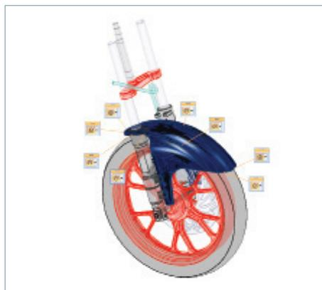
Les surfaces délimitées autorisent désormais l'utilisation de courbes guides pour un contrôle des formes accentué tout en prenant en charge les conditions aux limites des courbes continues afin de garantir un lissage des faces adjacentes. Grâce aux poignées de commande 3D et aux outils de visualisation de surface, comme les courbes UV et peignes de courbure, l'utilisateur bénéficie d'une expérience optimale.
