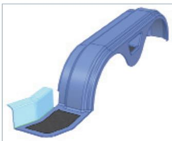
Désormais, il est également possible de créer des faces suivant profil par extrusion d'un profil qui représente le contour des faces suivant le profil.
