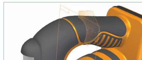
L'outil de contrôle de courbure facilite l'importation des modèles. Vous pouvez désormais détecter les défauts des pièces stylisées en affichant les contours surfaciques par rapport aux positions UV des diverses faces.
